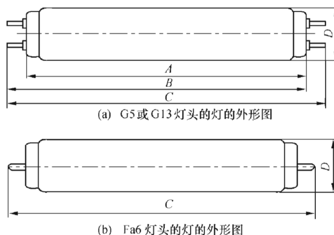
图 2-8 带 G5、G13 或 Fa6 灯头的灯外形尺寸图
