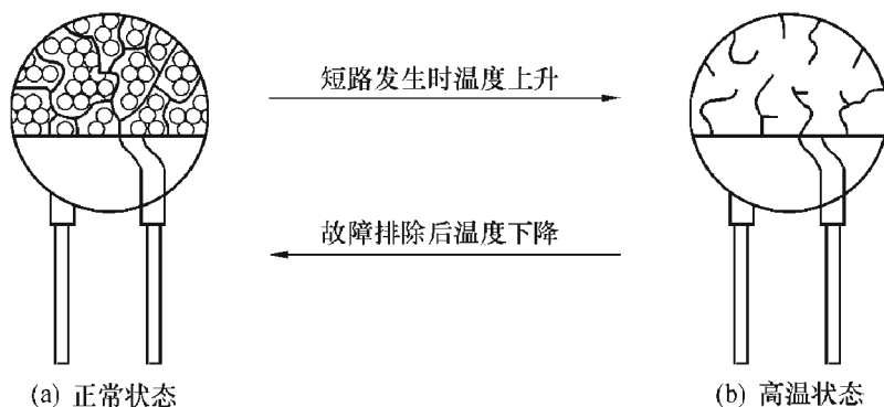
图 9-12 Polyswitch 工作原理
